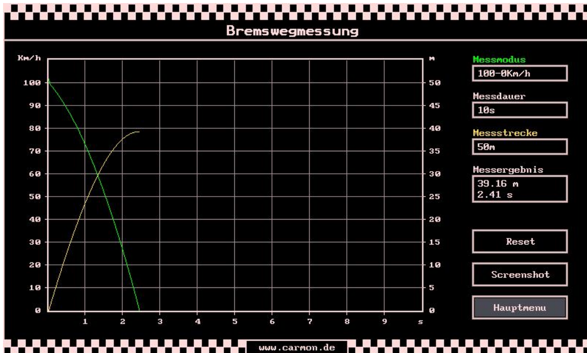
beispielhafte Bildschirmansicht (Messung 100-0Km/h in 39.16m)
