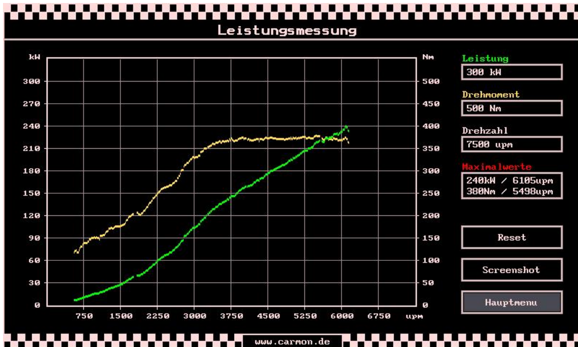
beispielhafte Bildschirmansicht (Messung P_{\max} = 240\text{kW} / M_{\max} = 380\text{Nm} )
